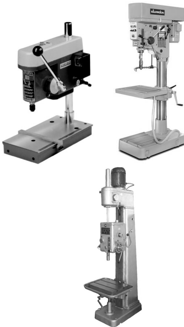
Rysunek 5.4. Wiertarka stołowa, wiertarka słupowa i wiertarka stojakowa
